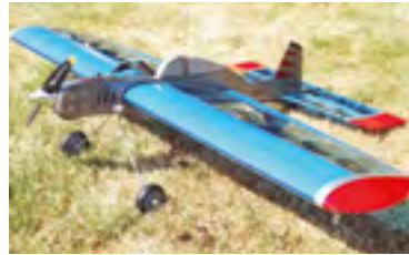
Zeigt ein typisches Trainermodell unseres Mitglieds Thomas Niedermayer. Angetrieben wird es mit einem Elektromotor, der über einen speziellen Fesselflugtimer angesteuert wird.
